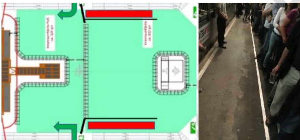
Bild 83: Sicherheitsgang im hinteren Bereich des Innenraums (Quelle: Bernd Belka, Special Security Services Deutschland)
